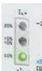
Abb. 7: Digitale Fehlerstromschutzschutzeinrichtungen informieren das Wartungspersonal über Probleme, ehe es zu einem Ausfall kommt
