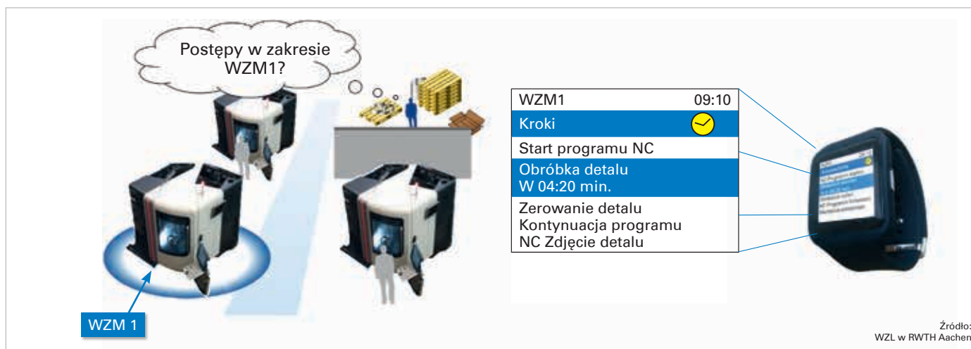
Rysunek 3.7: Wykorzystanie inteligentnych urządzeń do zdalnego monitorowania narzędzi maszynowych [BREC16],[MAXI16].
