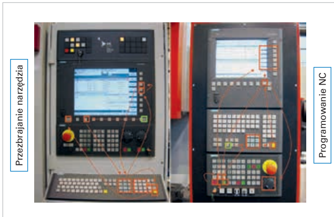
Rysunek 1.2: Kroki robocze w konwencjonalnym, zorientowanym funkcjonalnie układzie sterowania [KOLS14].
